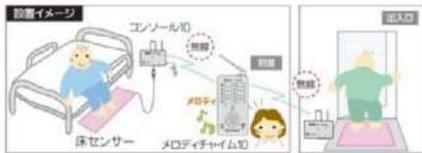
ベッドからの離床、移動等を検知し、無線で別室の介護者に知らせます。床のマットを踏むと発信し、受信器のメロディ音等で報知します。センサーの増設も可能です。
